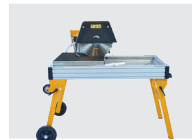
SÉRIE SDS Profondeur de coupe: 75-100 mm Longueur de coupe: 640-650 mm Disponible avec pieds fixes ou pliables
