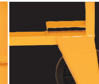
TRUCKFICKOR OCH LYFTKROK säkerställer enkel hantering under transport.
