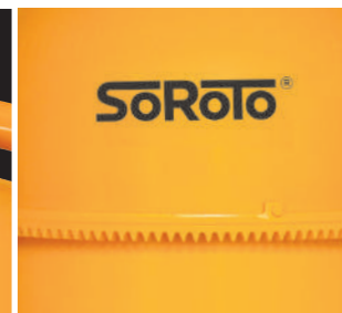
VÄXELRING AV GJUTJÄRN gör maskinen extra robust.
